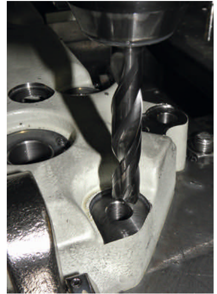
3 Die Kombination aus speziellem Hartmetall, modernem Design und neuer Beschichtung ertüchtigt den SDP-Vollhartmetallbohrer für schnelles Bohren und bislang unerreichte Standzeiten selbst bei Lunkern und unterbrochenem Schnitt. Dieses Werkzeug hat bereits mehr als 20 000 Bohrungen erzeugt!
